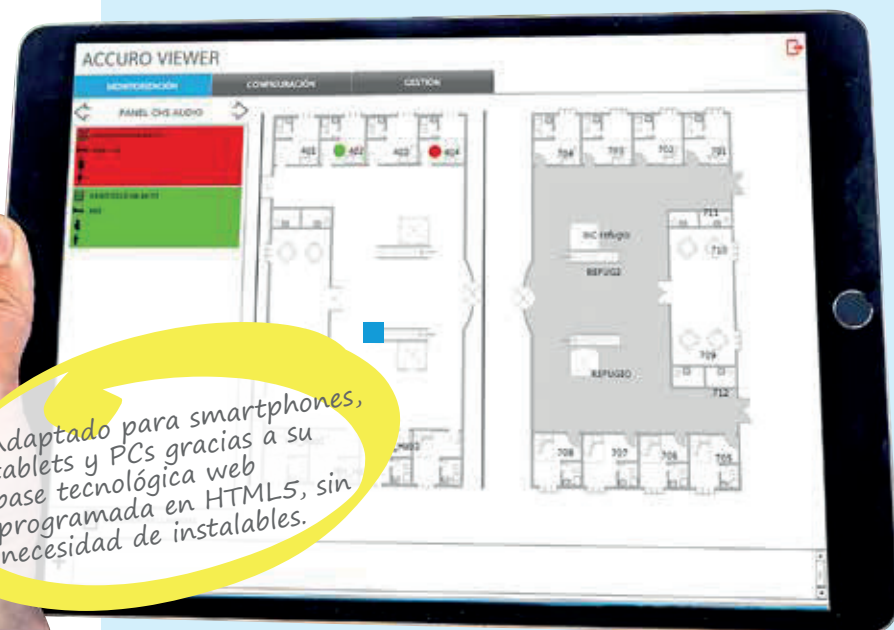
Ejemplo de visualización de las llamadas y alarmas en formato 'mapa' a través de ACCUROviewer, con indicación de los niveles de alarma y la presencia de paciente en la habitación.
